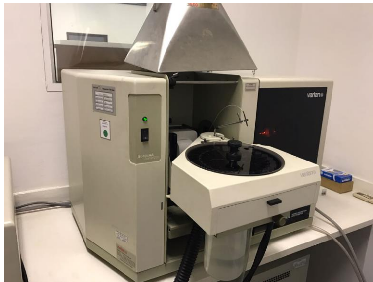
Figura 5 – Fotografia de perfil do Espectrômetro de absorção atômica com forno de grafite (Varian SpectrAA 220 Zeeman).
